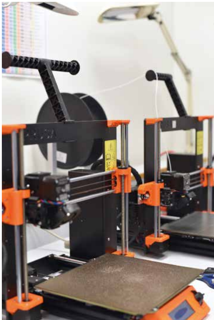
► Det var en lærling, der introducerede 3D-printerne i afdelingen. Nu bliver de brugt til at producere store og små reservedele – for meget få penge. Foto: Michael Gringer.
