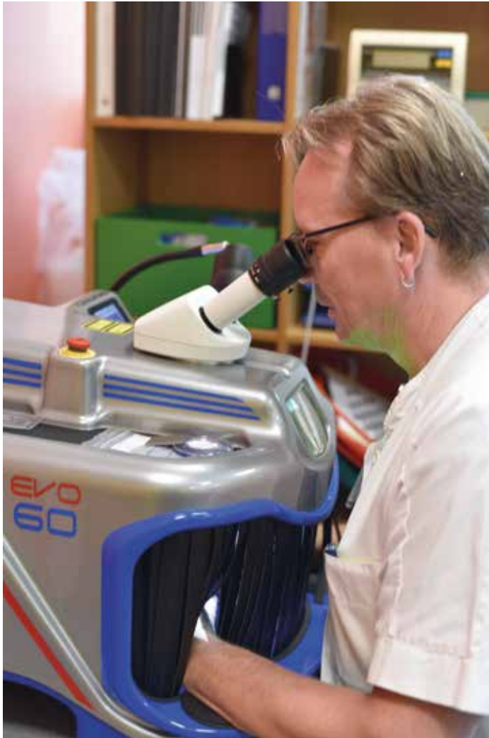
► Når Bo reparerer endoskoper, er der nogle gange så små revner, at det ikke kan ses med det blotte øje. Derfor er et mikroskop et brugbart værktøj. Foto: Michael Gringer.
