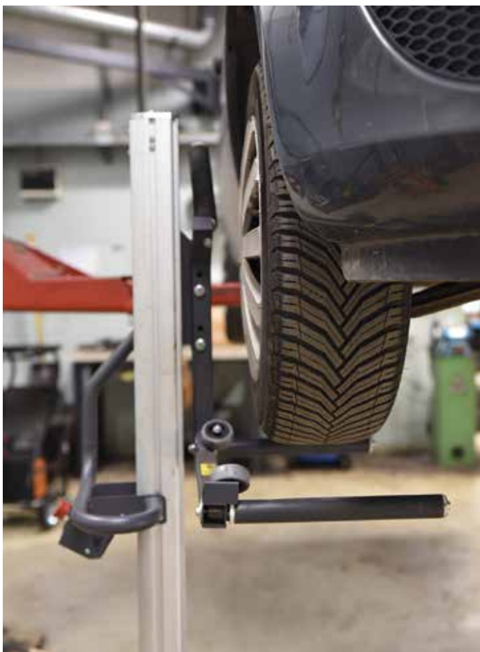
Mekanikerne hos Andersen & Martini i Søborg bruger kun hjulløftere til at løfte hjul og undgår dermed arbejdsbelastningen i ryggen.
