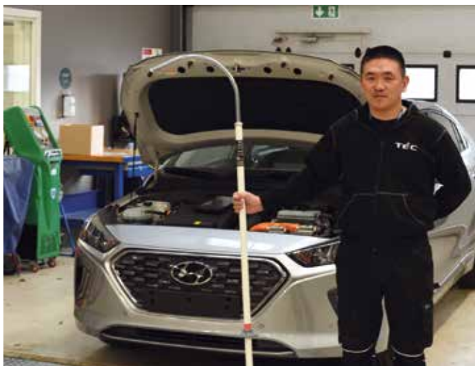
► Faglærer Benny Larsen med en hyrdestav, også kaldet teaterkrog, til at få trukket et menneske fri, hvis man laver en fejl og får strøm igen sig.
